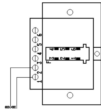
Bei einfachen Telefonanschluss mit einer TAE wird die ankommende Leitung auf 1/2 angeschlossen.
